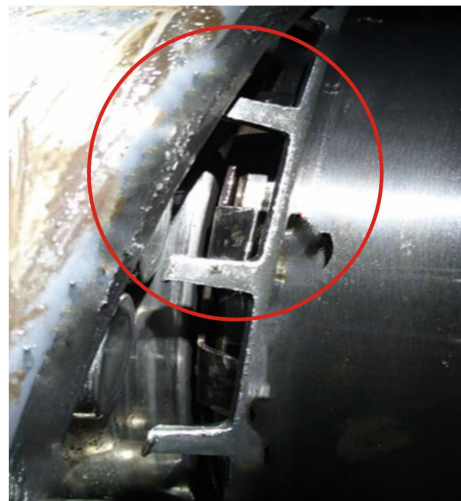
轴承保持架断裂
