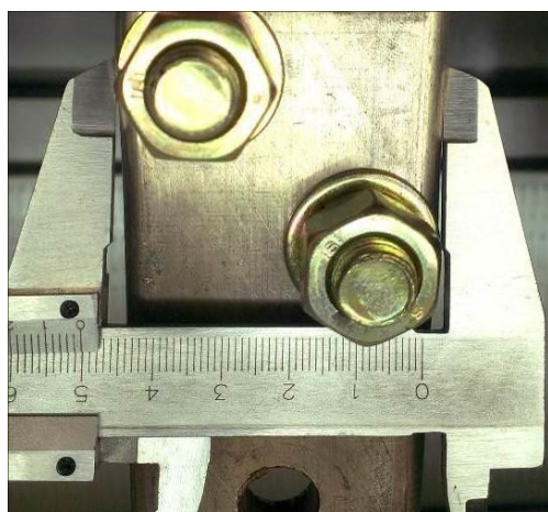
05-1 隔离开关进线宽度（50mm）
