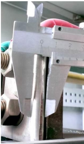
07-2 主塑料外壳式断路器进线母排宽度（10mm）
