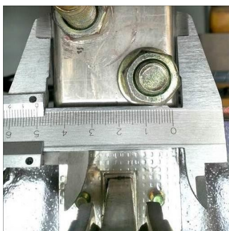
06-1 隔离开关出线宽度（50mm）
