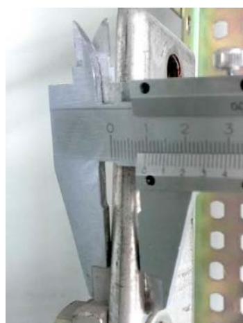
05-2 隔离开关进线厚度（10mm）
