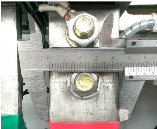
08-1 主塑料外壳式断路器出线母排宽度（50mm）
