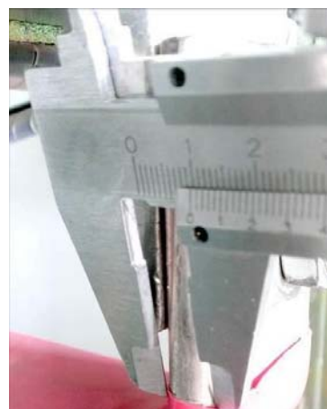
06-2 隔离开关出线厚度（10mm）
