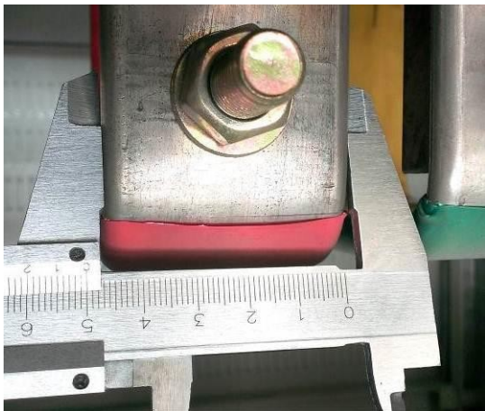
07-1 主塑料外壳式断路器进线母排宽度（50mm）
