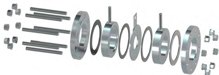
环室取压孔板爆炸图
